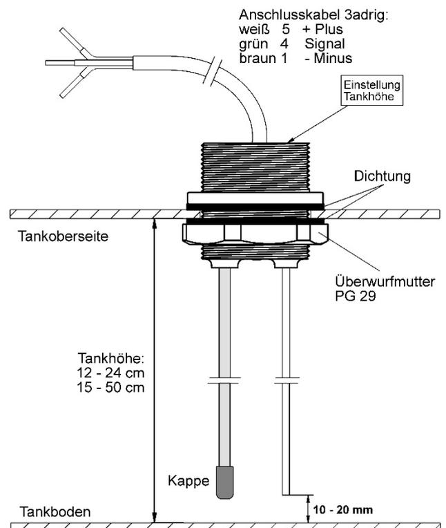
Danach werden beide Stabsonden auf gleiche Länge gekürzt (Metallsäge, kräftiger Seitenschneider, Bolzenschneider).
