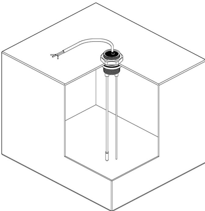
Die **Tankelektrode K** wird zur Füllstandsfernmessung direkt am Tank montiert und ist geeignet für:
